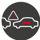
В городе система City Safety поможет вам предотвратить столкновение в тот момент, когда автомобиль, идущий впереди, резко остановится или снизит скорость. Наша система автоматически затормозит на скорости до 50 км/ч – столкновения можно избежать в случае, если разница в скорости с впереди идущим автомобилем будет до 15 км/ч.
