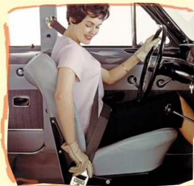
1964 Первое сиденье для детей, устанавливаемое против направления движения (прототип)
